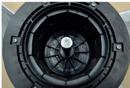
Ocelový rotor s umělohmotným chladicím kolem
