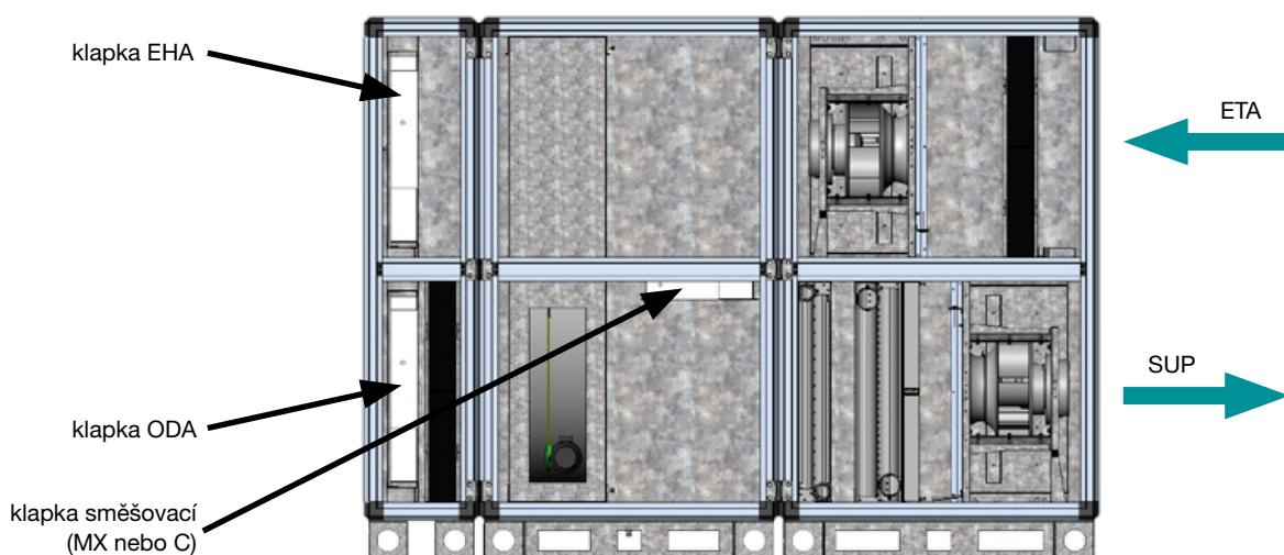
**Režim směšování (MX)** – klapka ODA + EHA otevřeny na 100%, klapka MX otevřena dle požadovaného množství směšovacího vzduchu.
