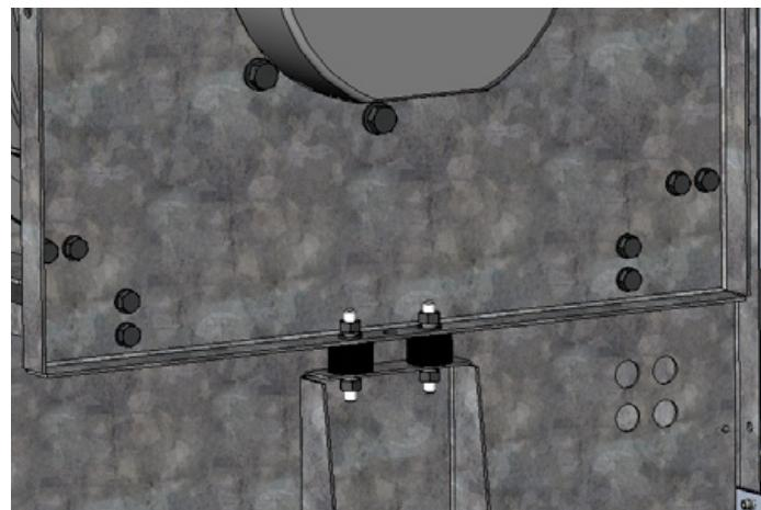
matice M8 (2 ks) silentbloku pod motorem ventilátoru
