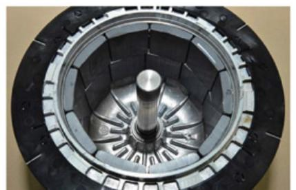
rotor z Al tlakového odlitku s umělohmotnou deskou (není znázorněna) na prstenci
