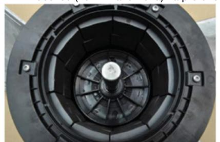
ocelový rotor s umělohmotným chladicím kolem
