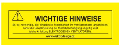
HINWEIS ZUM ANSCHLUSS DES MOTORSCHUTZES DES VENTILATORS
