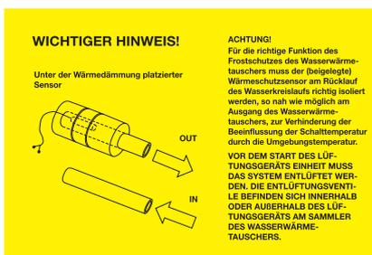
HINWEIS ZUR NOTWENDIGKEIT DER ISOLIERUNG DES BEIGELEGTEN FROSTSCHUTZSENSORS
