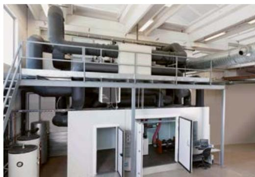
Klimakammer für die Prüfung von Rückgewinnungsgeräten
