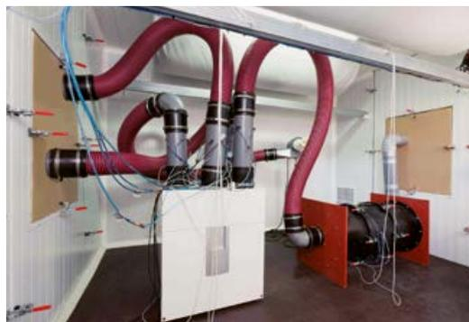
Prüfanlage für die Kontrolle der Parameter von kleinen Rückgewinnungsgeräten, es werden 100 % der Produkte getestet, einschließlich der Archivierung von Daten
