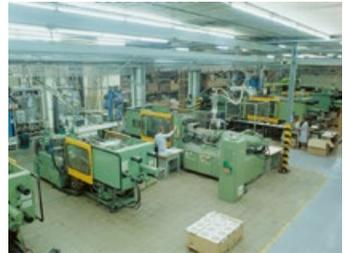
Herstellung von Spritzgussteilen aus Kunststoff
