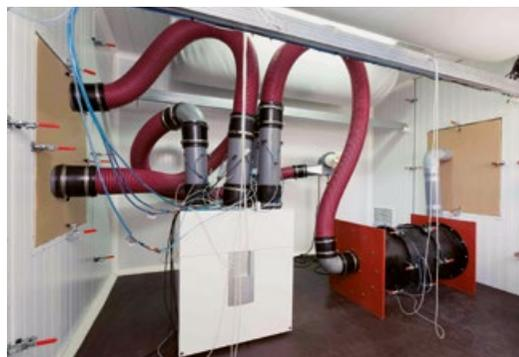
Prüfanlage für die Kontrolle der Parameter von kleinen Rückgewinnungsgeräten, es werden 100 % der Produkte getestet, einschließlich der Archivierung von Daten
