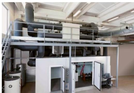
Klimakammer für die Prüfung von Rückgewinnungsgeräten
