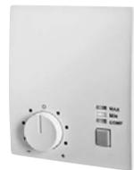
Modus ermöglicht die Fernbedienung eine stufenlose Einstellung des Luftdurchflusses durch den Drehknopf. Der MIN Modus kann auf 0 % Luftdurchfluss eingestellt werden (Regelklappe ZU). Der MAX Modus ermöglicht den maximalen Luftdurchfluss (Regelklappe ganz AUF). Sie ist zur Befestigung an der Wand des Raumes bestimmt. Wir empfehlen sie an der Eingangstür der Wohneinheit zu platzieren.
